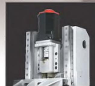
Для этой конструкции станка не требуется наличие противовеса. Привод оси Z с системой торможения обеспечивает оптимальную скорость подачи и точность позиционирования.
