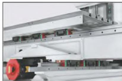
Линейные направляющие для работы в тяжелых режимах и опорные блоки увеличенного размера, установленные на всех трех осях. Стандартная скорость быстрого подвода 32 м/мин.
