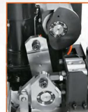
Система смены инструмента (BT#30) с двойным манипулятором обеспечивает время смены инструмента в течение всего лишь 0,9 сек.
