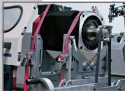
Динамическая балансировка двигателя шпинделя обеспечивает минимальный уровень вибрации и максимальную точность обработки.
