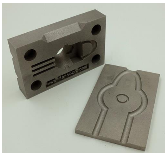
Изделия, напечатанные из нержавеющей стали 17-4 PH на системе FS271M
