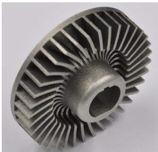
Образцы из стального порошка 316L , напечатанные на установке FS271M
