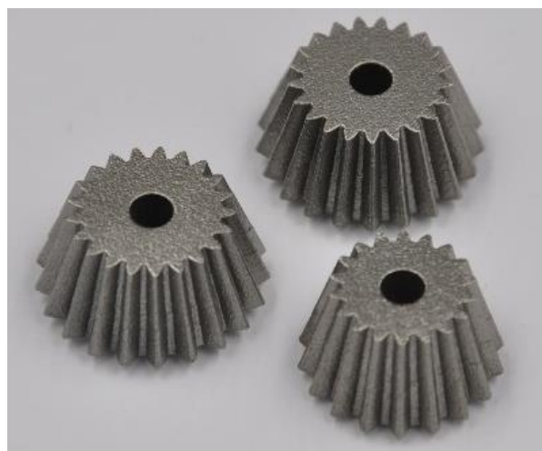
Изделия, напечатанные из нержавеющей стали 17-4 PH на системе FS271M
