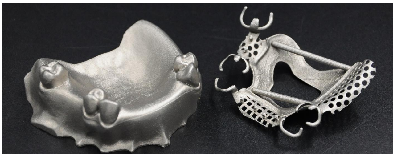
Имплантаты для челюстно-лицевой хирургии, напечатанные из металлического порошка Co-Cr (биосовместимого) на 3D принтере FS271M
