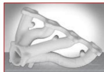
Модельная оснастка, созданная на 3D принтерах по технологии SLS, обладает высокой стойкостью. Производитель рекомендует покрывать поверхность модели эпоксидной смолой для достижения физико-механических свойств, указанных в таблице. Для увеличения срока службы и экономии расходного материала создается полая оснастка, которая впоследствии заливается эпоксидной смолой, упрочняющей изделие изнутри.
