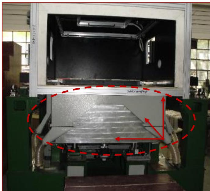
Объем рабочей зоны определяется как соотношения габаритных размеров платформы построения (по осям X и Y) и длины хода платформа по оси Z
