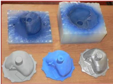
Установки серии **HPRS** могут быть использованы в технологическом процессе производства моделей из литейного воска или парафина. Трудоемким этапом является создание оснастки или разборной пресс формы для формирования “восковок”. Промышленные 3D принтеры позволяют оптимизировать данный процесс сохраняя все преимущества технологии литья по выплавляемым моделям.
