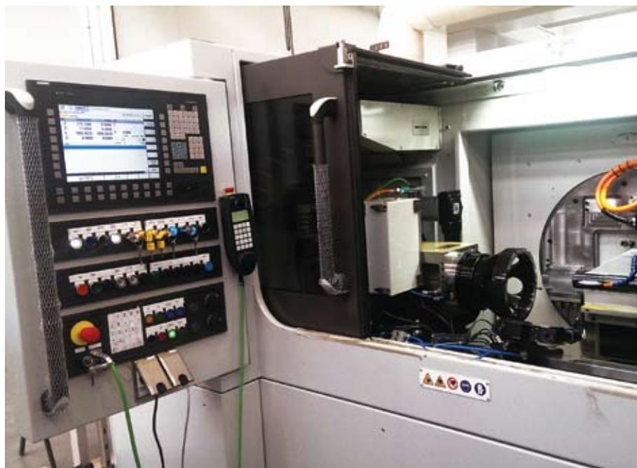
суппорт. В этом случае все инструменты главного шпинделя закреплены на одном суппорте. На более сложных моделях появляются дополнительные независимые суппорты и линейные оси. Самый сложный станок имеет 10 линейных осей и 4 независимых суппорта. Это дает возможность установить большее количество инструментов, а также равномерно распределить операции между главным и контршпинделем. Эти операции выполняются в главном и контршпинделе одновременно, что существенно сокращает время обработки.
