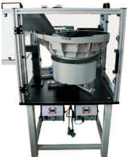
Загрузка заготовок при помощи пневматического загрузчика
