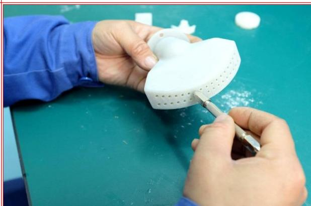
*Очистка модели из полиамида с помощью сжатого воздуха / продувка сложно доступных мест и систем каналов*
