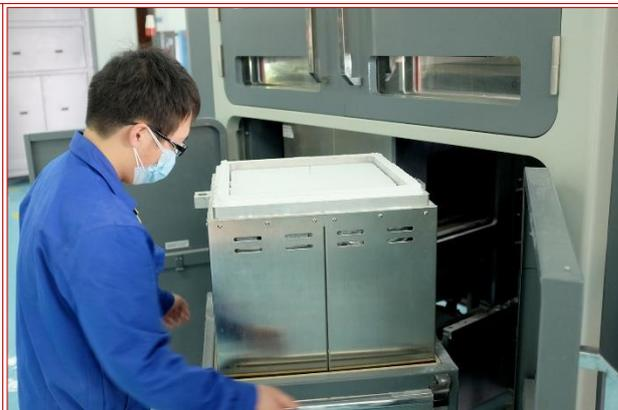
*Разгрузка бункера для построения из установки FS402P*
