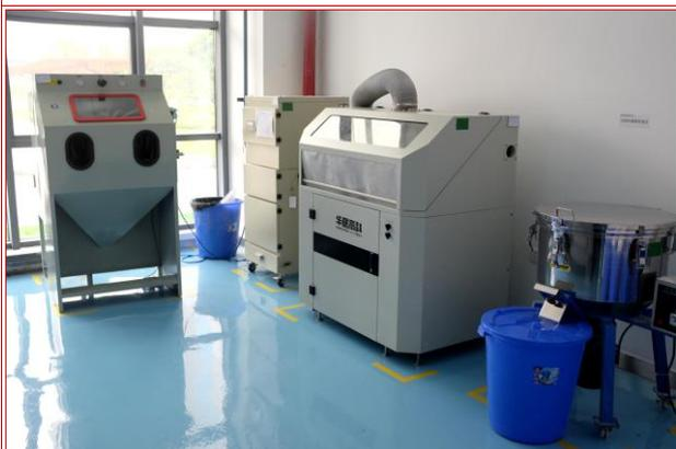
*Комплекс дополнительного оборудования: система восстановления неотверждённого порошка, пескоструйная установка, рабочее место для разгрузки бункера*
